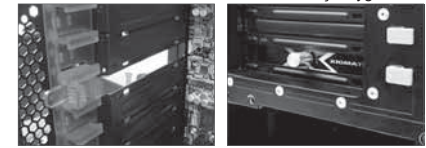
G) Eklenti kartı için aletsiz kitleler H) Eklenti kartı braketinde aynı zamanda üç fan için Fan hız kontrolörü
